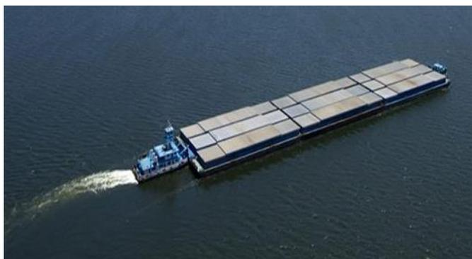
Figura 1: Comboio de barcaças graneleiras e empurrador.
