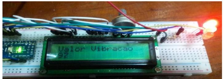
Figura 7: Níveis de vibrações dentro dos valores < 40Hz.
