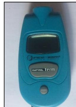
Figura 16: Termômetro infravermelho digital.
