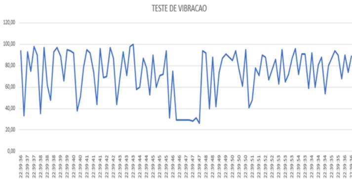
Figura12: Assinatura espectral alterada após a realização de pressão sobre o equipamento
