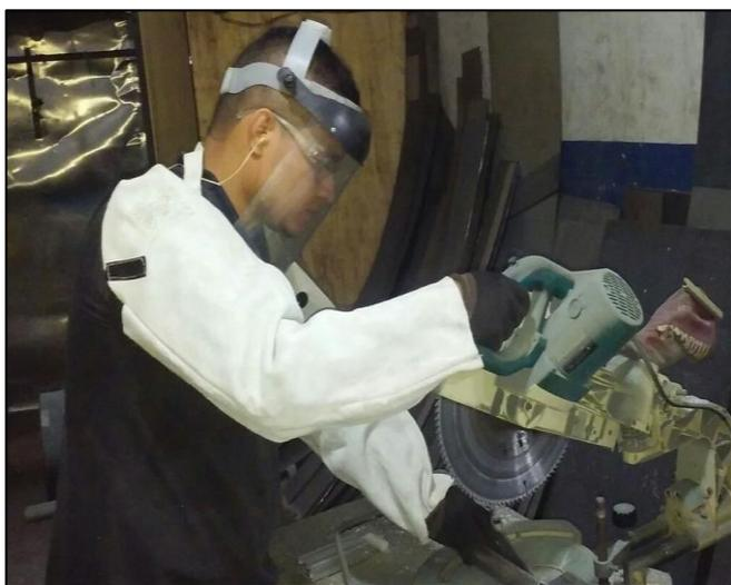
Figura 13: Operação Serra elétrica policorte Makita LS1214.
