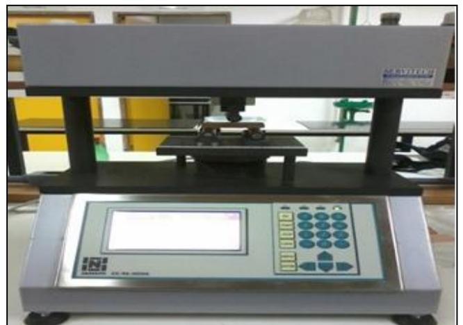
Figura 3: Flexímetro utilizado para ensaios de tensão de ruptura e flexão nos corpos de prova.
