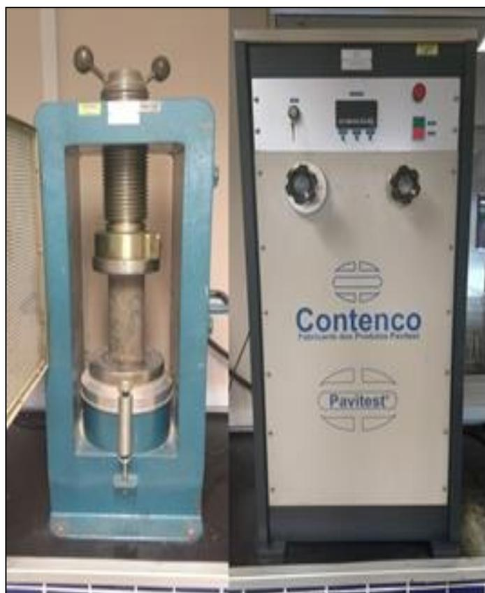
Figura 4: Prensa hidráulica utilizada para ruptura de corpos de prova de concreto.
