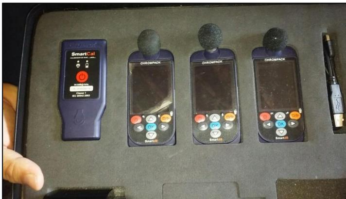
Figura 10: Equipamento Dosímetro smartdB Chrompack
