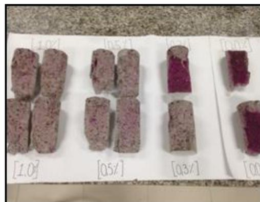
Figura 10: Corpos de prova de concreto exposto após aplicação do indicador químico de fenolftaleína, com ênfase das porcentagens das fibras de malva.
