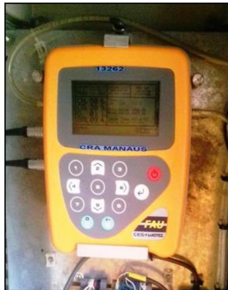
Figura 8: Analisador de Gases – FAU.
