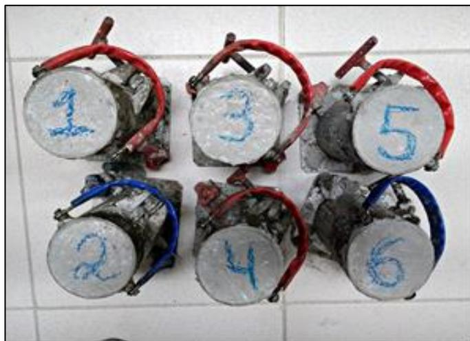
Figura 3: Corpos de prova de concreto endurecido, 24 horas pós moldagem no tamanho 10/20 cm seguindo as especificações.
