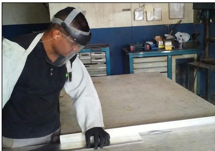
Figura 12: Operação com Bancada de corte – motor Eberle B100 L4.
