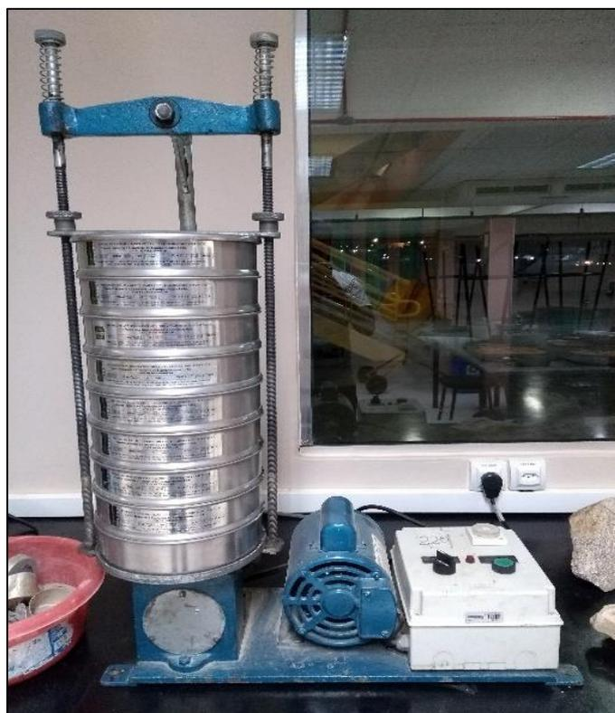
Figura 2: Agitador de peneira utilizado para a análise e caracterização dos agregados graúdo e miúdo (areia, brita e seixo).
