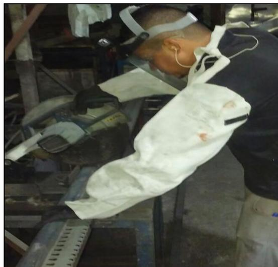
Figura 14: Operação Serra elétrica policorte Bosch GCO 2k.
