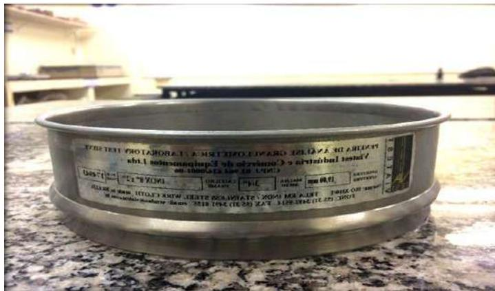
Figura 4: Peneira de 19'' mm utilizada em análise granulométrica.
