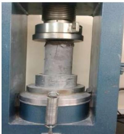
Figura 4: Corpo de prova sendo rompido.
