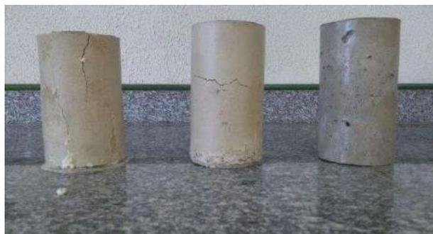
Figura 11: Cp's com concentrações diferentes de açúcar.
