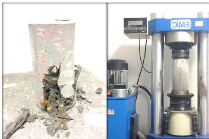
Figura 11: Rompimento do corpo de prova.
