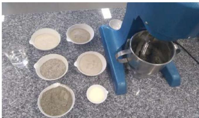
Figura 7: Materiais e equipamento de mistura da argamassa.
