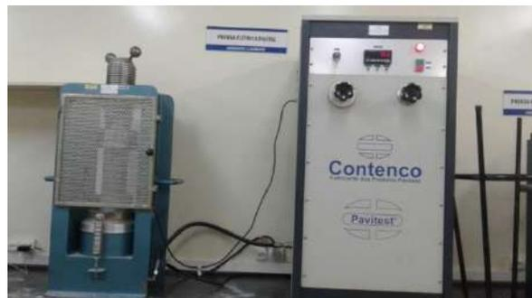
Figura 3: Prensa elétrica digital utilizada nos ensaios de resistência a compressão.
