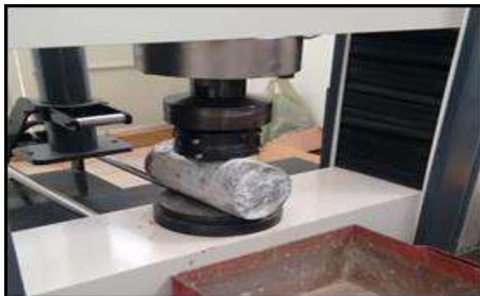
Figura 3: Tração por compressão diametral.
