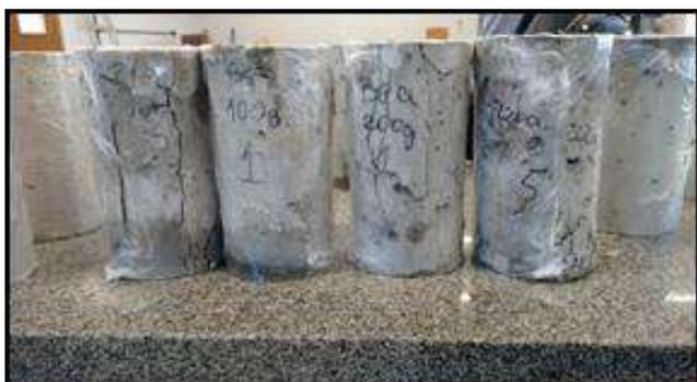
Figura 2: Corpos de prova rompidos aos 28 dias.
