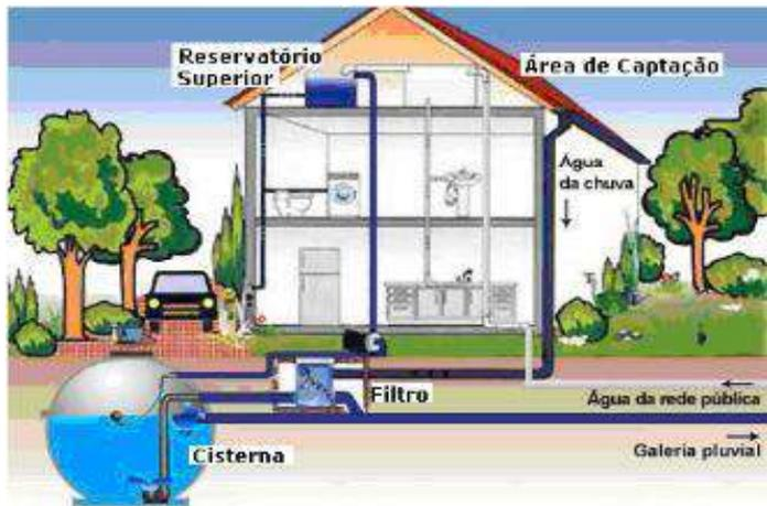
Figura 1: Esquema de funcionamento de sistema aproveitamento de água de chuva.
