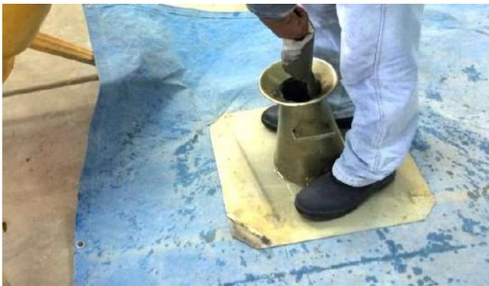
Figura 5: Procedimento de moldagem (*Slump test*).
