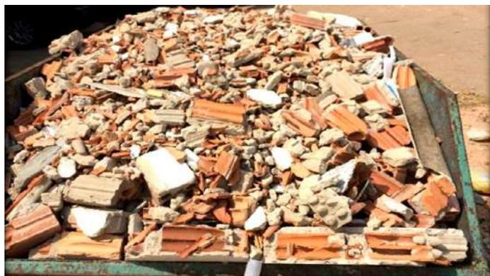
Figura 2: Resíduos de construção e demolição (RCD) coletados.
