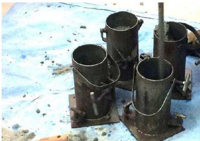
Figura 8: Adensamento e moldagem dos corpos de prova.
