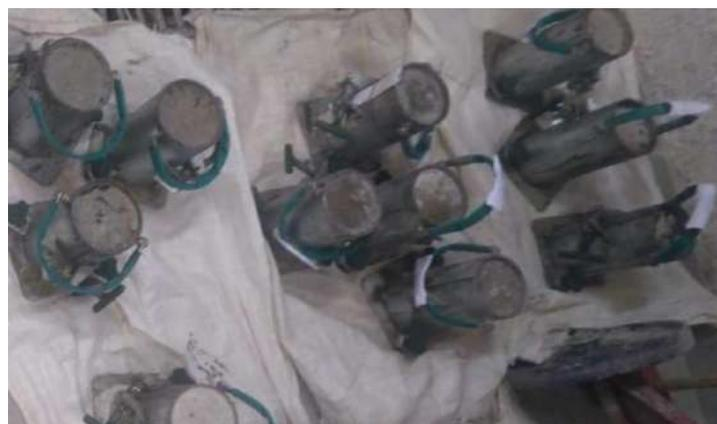
Figura 4: Corpos de prova em forma.
