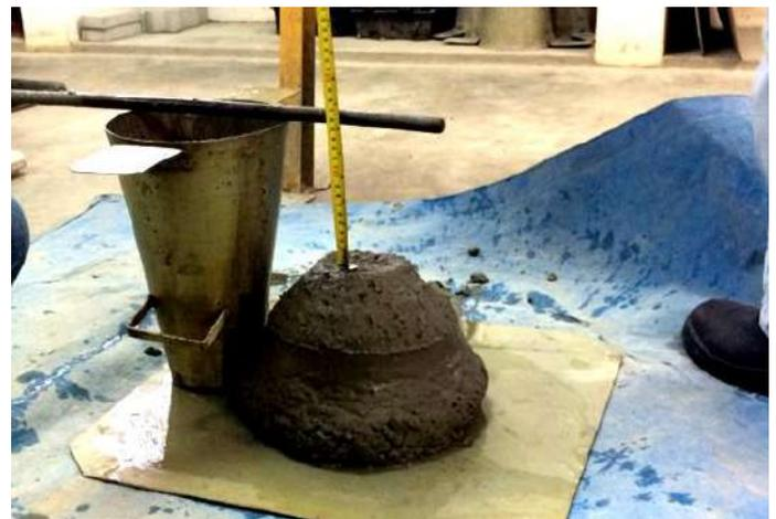
Figura 7: Altura média da amostra assentada (*Slump test*).
