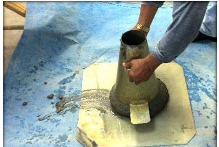
Figura 6: Procedimento de moldagem (*Slump test*).
