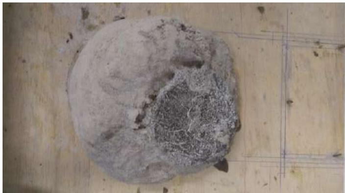
Figura 10: Corpo de prova que não ocorreu a pega.
