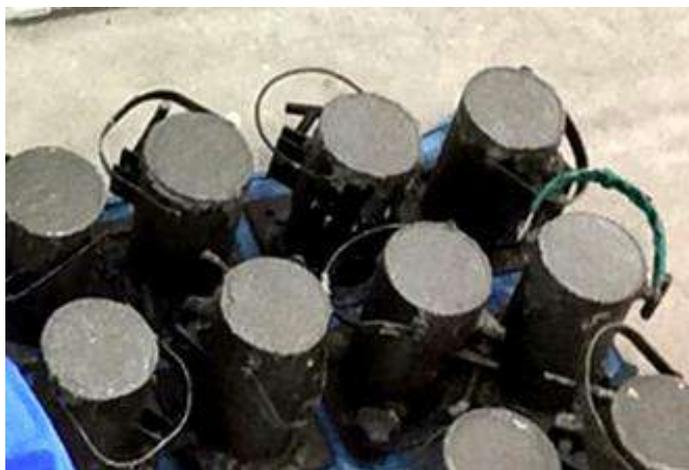
Figura 9: Moldagem dos corpos de prova.
