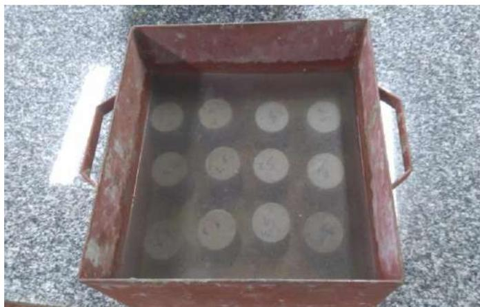
Figura 8: Corpos de prova imersos.
