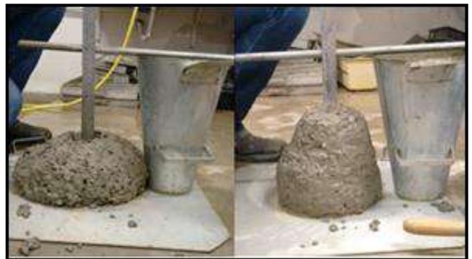
Figura 1: diferença de abatimento do concreto entre o Traço 1 (esquerda) e Traço 2 (direita).
