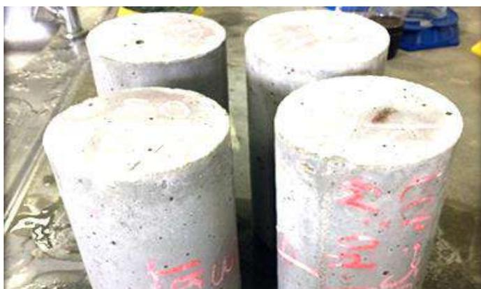
Figura 10: Corpos de prova indenticados prontos para rompimento.
