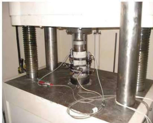
Figura 13: Ensaio á Compressão axial.
